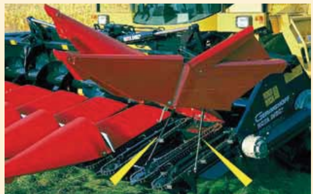
提高保护：工业气弹簧保护重盖子。
